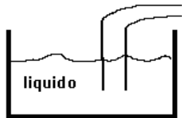
sensore di livello tramite conduttanza
